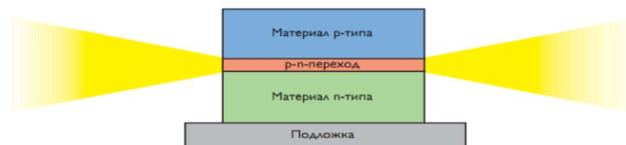
Рисунок 1.3 – Схема работы светодиода
